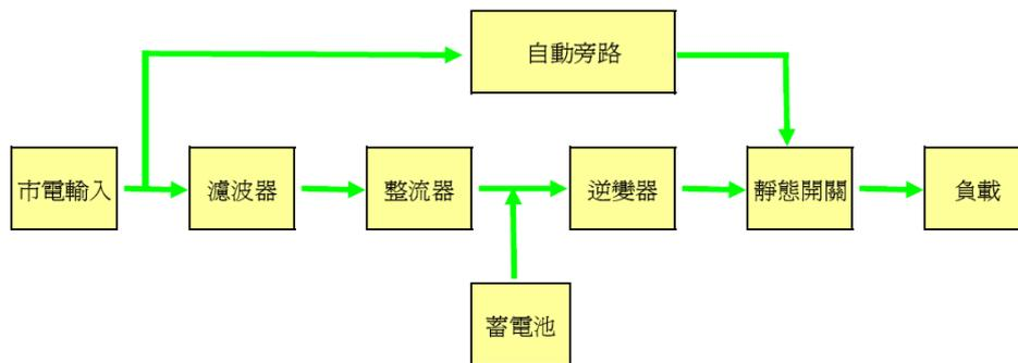
UPS 系統是由輸入無熔絲開關 ( Input Breaker )、輸入濾波及保護電路( Input Filter & Protection Network )、整流器 ( Rectifier )、逆變器 ( Inverter )、靜態開關 ( Static Switch )、自動旁路系統 ( Bypass System )、及電池組 ( Battery Bank)等組成，基本架構圖如上圖所示。本 UPS 係為全數位控制脈寬調變(PWM)之靜態在線式(ON-LINE)不斷電系統，在正常市電下，交流電源經過整流器及濾波板轉換為直流電源，供電給逆變器並對電池組充電，使電池儲存足夠的電能，以便在市電中斷時，在零轉換時間狀況下馬上提供乾淨電力給負載使用。
